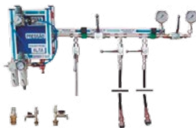
EQUIPO PARA RETIMBRAR EXTINTORES. TEST HIDRÁULICO. EQUIPO PARA RETIMBRAR EXTINTORES. TEST HIDRÁULICO.
