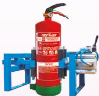
MORDAZA PARA SUJECIÓN DE EXTINTORES NEUMÁTICA.
